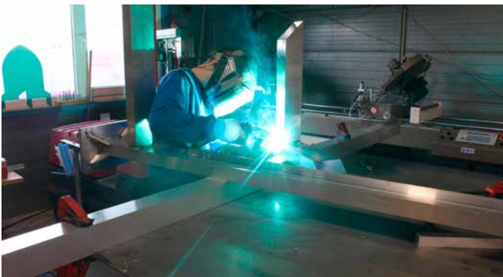
In de werkplaats is een lasser bezig met het lassen van een constructie voor een grote lichtzuil.
