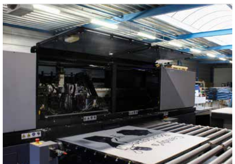
De vlakbed UV-printer voor het printen op pvc vrij materiaal.
